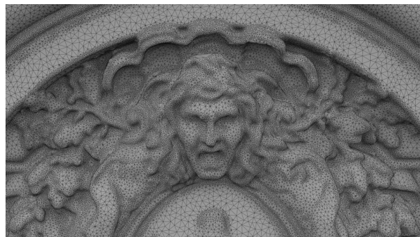
(c) Vue rapprochée de la triangulation générée sur une autre partie.
