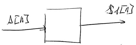
note le filtre peut comporter des sur échantillonnages et/ou des sous échantillonnages
