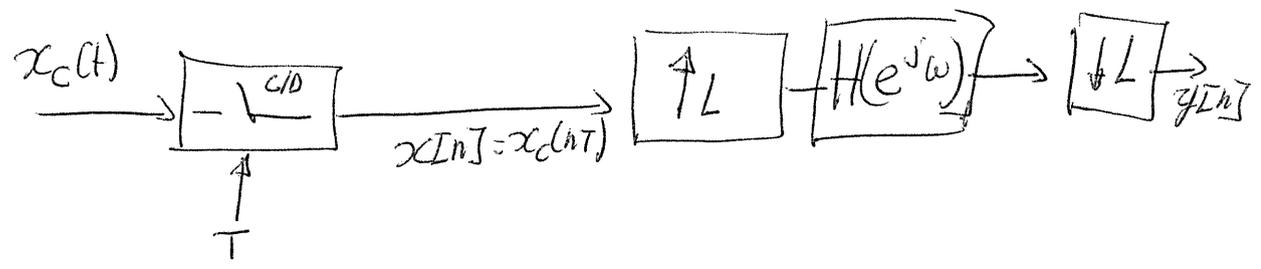
avec  $X_c(j\Omega) = 0 \quad |\Omega| \geq \frac{\pi}{T}$
