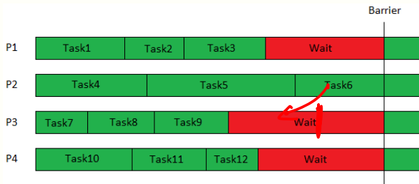
FIGURE – Un probleme d'equilibrage de charges avec 12 taches et 4 postes de travail.
