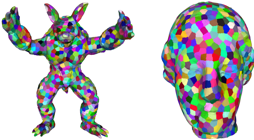
FIGURE 52 – Diagrammes de Voronoï de points 3D calculés au fil de l'eau à partir de graphes locaux interconnectés [BPA22].
